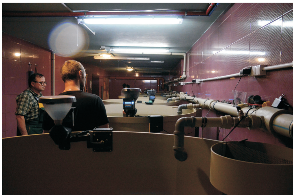
Fot. 3. System RAS, w którym wdrażana była technologia podchowu narybku szczupaka (fot. Z. Zakęś).
